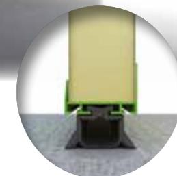
En partie basse, U en polythermalyné collé et popé assurant la rupture de pont thermique entre l'extérieur et l'intérieur
