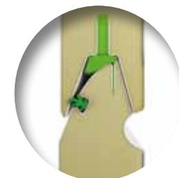
2 joints entre panneaux pour renforcer l'étanchéité
