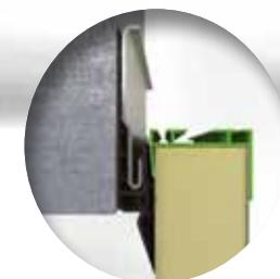
En partie haute, U en polythermalyné collé et popé assurant la rupture de pont thermique entre l'extérieur et l'intérieur
