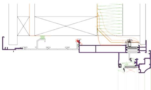
Le concept ATLANTEM MOB Easy permet d'adapter les menuiseries ATLANTEM Cosmos pour une pose dans un mur ossature bois jusqu'à 385 mm d'épaisseur.
